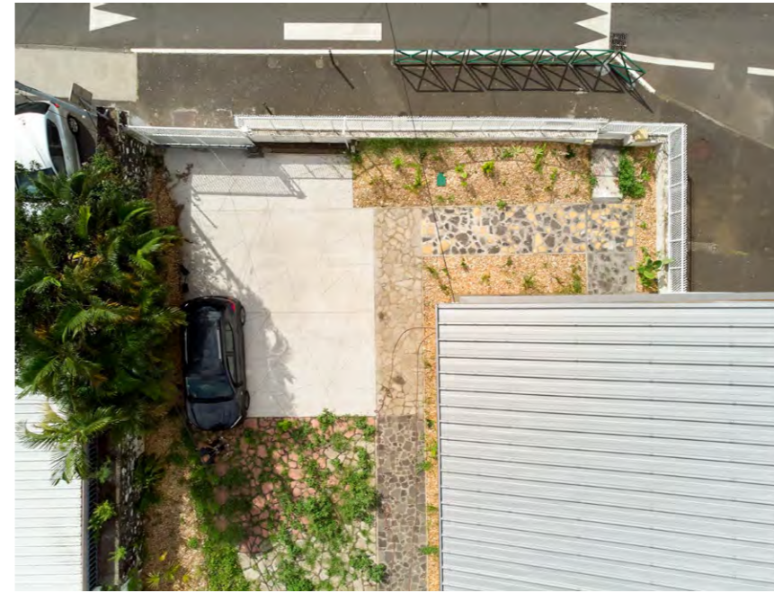
Les dallages variés de l'espace extérieur sont issus du réemploi.
