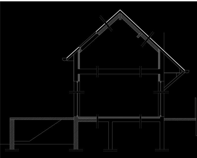
Détails - Projet - isolation et traitement des ponts thermique au standard « bâtiment passif »
