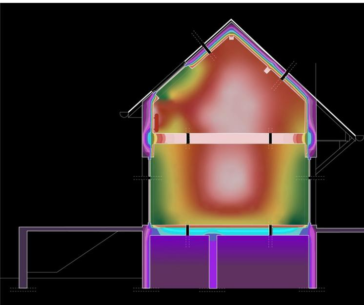
Confort - Projet - isolation et traitement des ponts thermique au standard « bâtiment passif »
