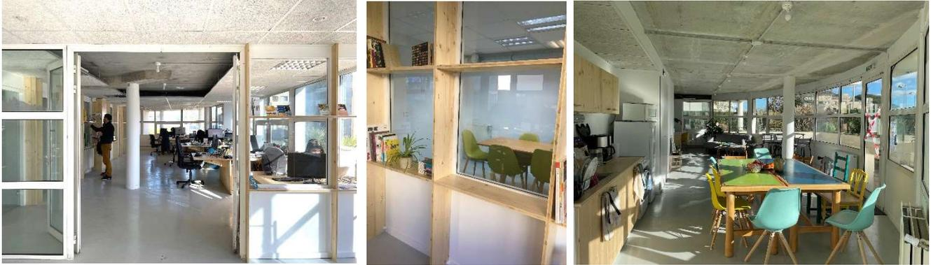
Le béton existant retrouvé après la purge et laissé brut sur une grande partie du projet n'est plus uniquement structurel et participe aux comforts d'usages, notamment au confort d'été grâce à son inertie naturelle qui diminue les pointes de température.
